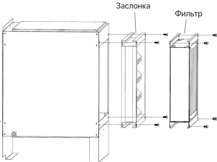
Для установки заслонок или фильтров на корпусе, необходимо ввинтить винты M8, которые поставляются в комплекте аксессуаров, в гайки, размещенные на самом корпусе. Для установки фильтров на заслонку нужны как винты M8, так и гайки.
