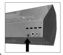
снова работать. В этом случае необходимо установить причину и предупредить, таким образом, повторение неисправности. (Возможными причинами неисправности могут быть, например: перекрытие всасывания или выпуска воздуха у завесы, слишком горячий всасываемый воздух, засорение электрического нагревательного элемента пылью и т.д.)
